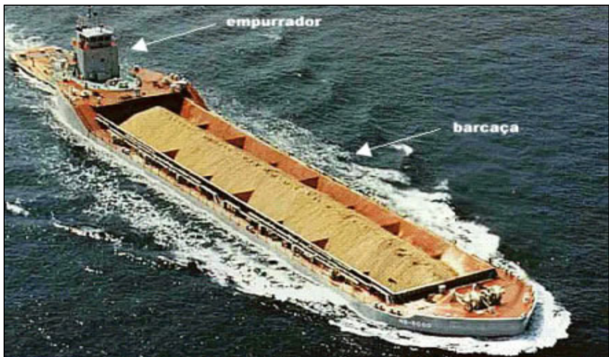
Figura 7 – Empurrador e barcaça acoplados por 2 pontos articulado. ( Taisei Engineering Consultants Inc. , 2006).
