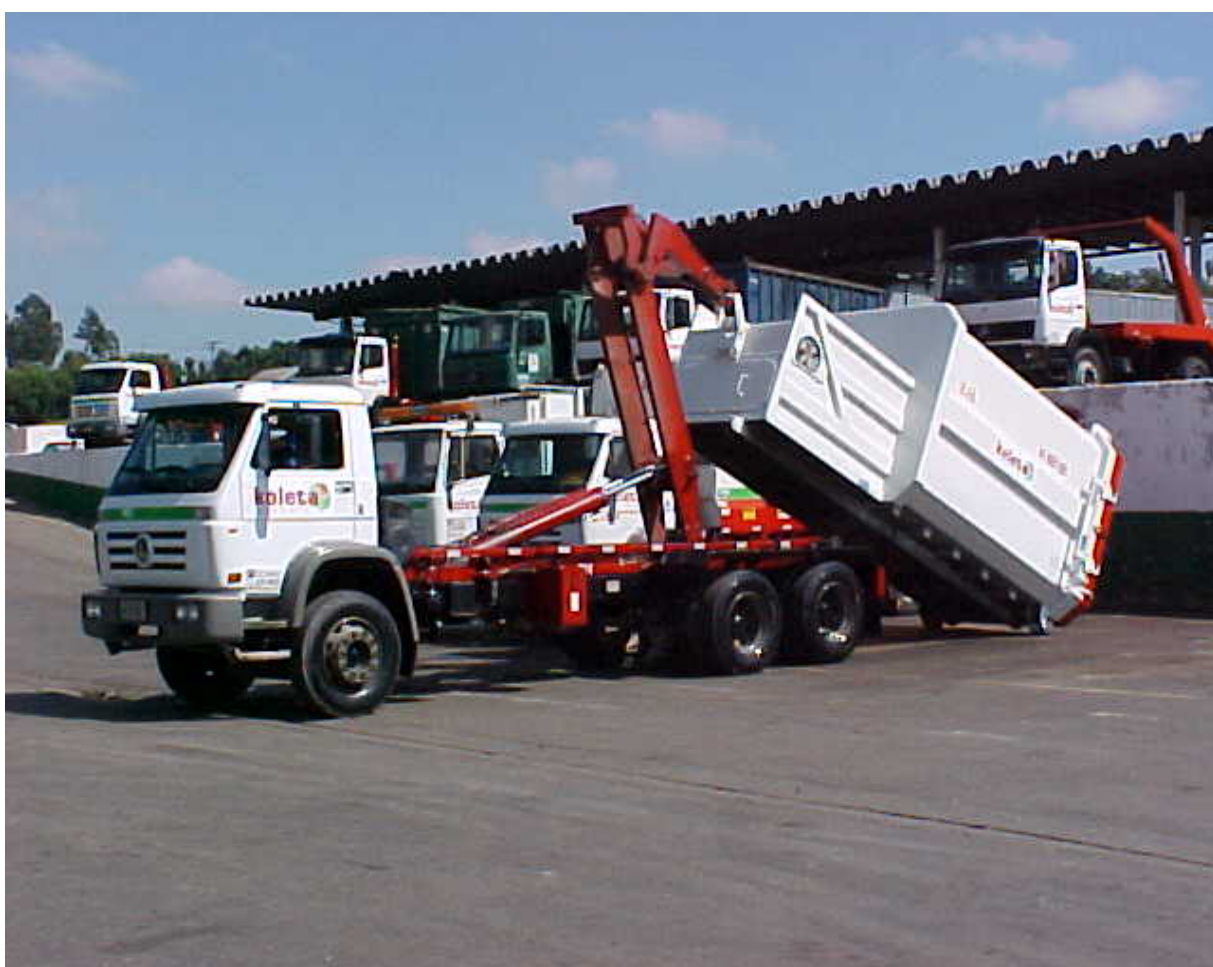
Figura 03: Caminhão Roll on / Roll off com Caixa Compactadora Estacionária Fonte: Koleta Ambiental S/A (2005)
