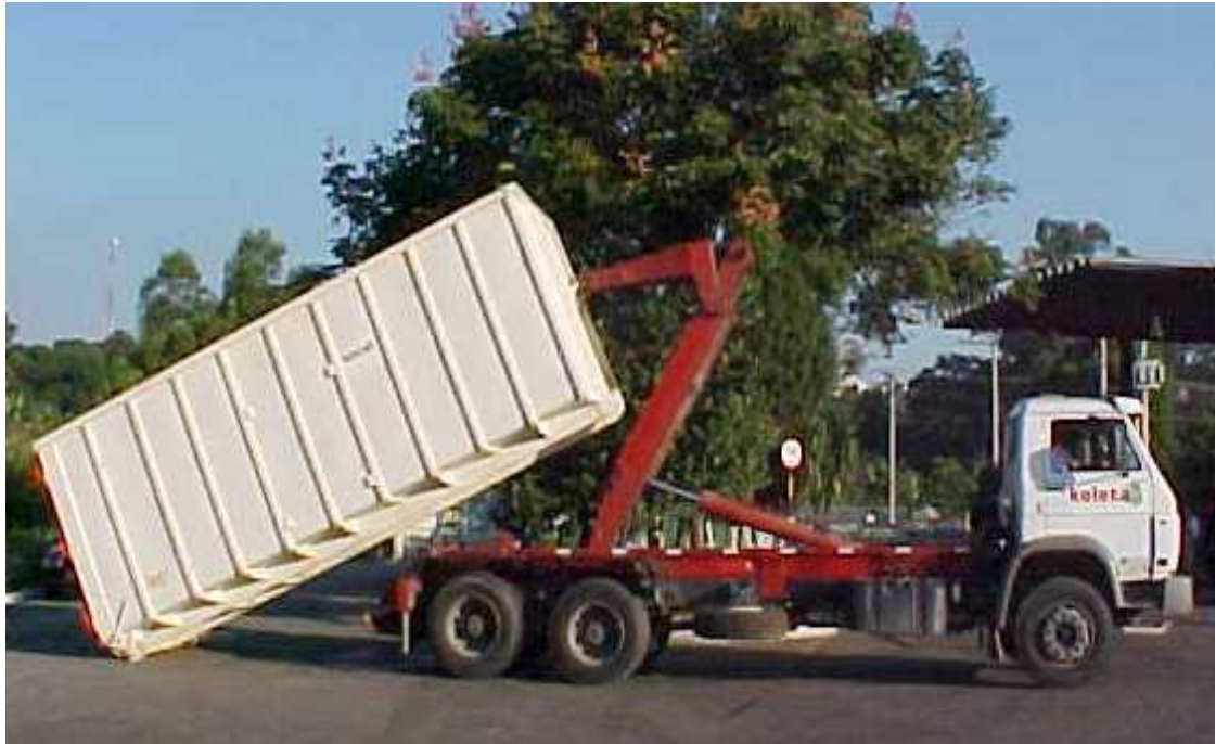
Figura 04: Caminhão Roll on / Roll off com Caixa Roll on / Roll off Fonte: Koleta Ambiental S/A (2005)
